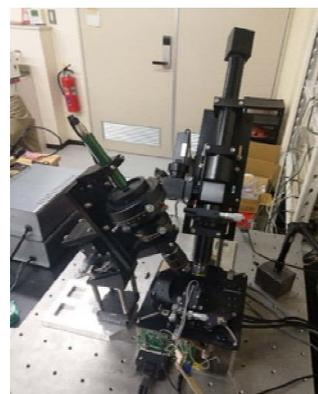
図 8 開発した磁気光学近接場光学顕微鏡 (MO-SNOM ver. 2) 主要部
