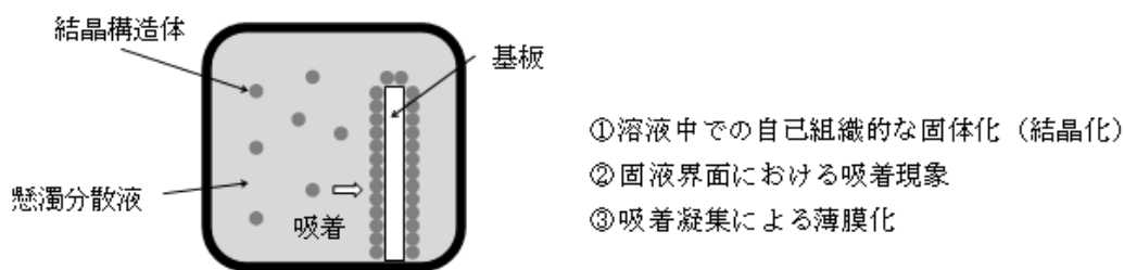
Fig.1 懸濁分散液中吸着堆積（ADS）法とその特徴
