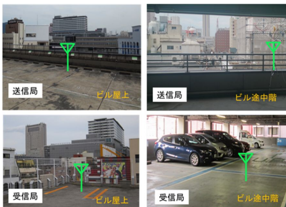
図4 屋外から屋外・建物侵入損失の測定 (立体駐車場)
