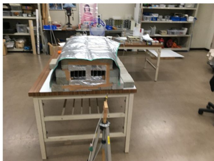
図2 建物侵入損失の測定 (スケールモデル) 図3 建物侵入損失の距離特性 (スケールモデル)
