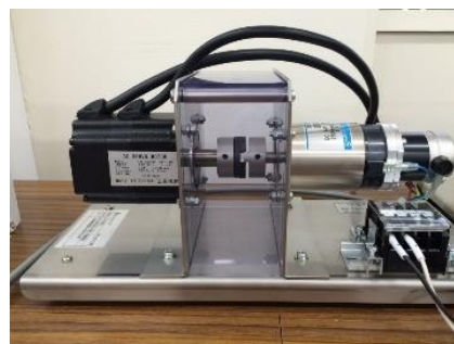
Fig. 2 永久磁石同期モータ実験装置
