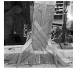
図 11 シートの損傷
