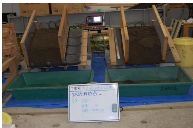
写真3 排水試験の実験装置の構成
