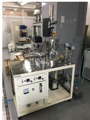
図2 新規開発した AlN/サファイア作製装置の外観。
