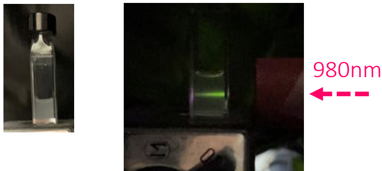
Fig. 6: マクロモノマーによる表面修飾処理後, エタノール-ヘキサン溶媒に分散させた溶液を光学セルに入れ, 側面から 980 nm-LD を照射したところ, レーザー光路に沿ってアップコンバージョン発光が目視により観測された.
