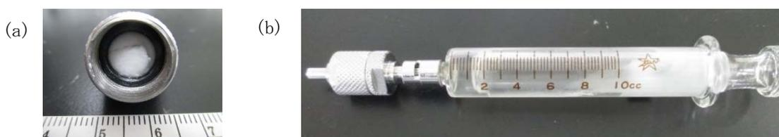
図2 ステンレス製フォルダー内のモノリス (a)とシリンジに装着した状態(b)
