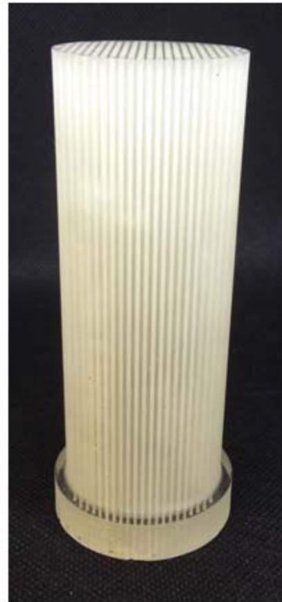
図5 造形したロケット燃料
