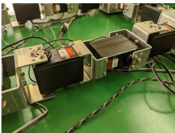
図 ユニット部の様子(法曲率を調整するモータと測地的曲率を調整するモータが付いている)
