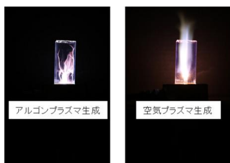
図 4 熱平衡プラズマによるアルゴンおよび空気のプラズマ化
