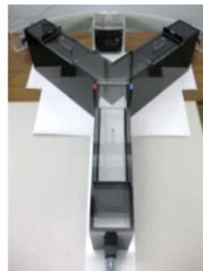
図1. Y字型迷路。片方の短腕に嫌悪臭である酪酸を置き、回避率を測定した。
