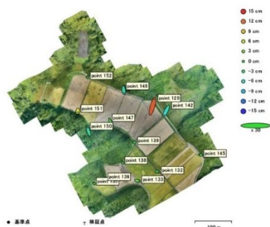
項目 3. GCP 位置と誤差の推定値。 Z エラーは枠内の色、X Y エラーは枠内の形状によって表現されます。 GCP の推定位置はドットまたは十文字でマークされます。
