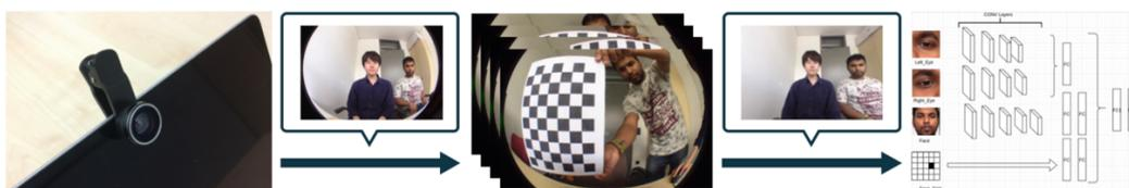
図4 広角レンズの歪み補正と Convolutional neural network による視線推定
