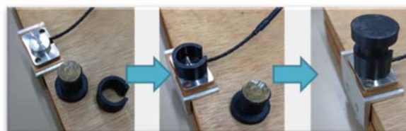
図 3 ボタン型トルク教示機構
