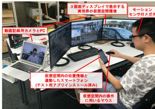
図 2 ユーザ評価環境のプロトタイプ
