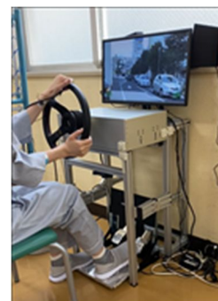
図2: 本研究で作成した簡易版の自動車運転認知行動評価装置
