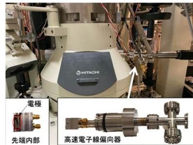
図4 SP-TEMの蛍光板上部に配置された高速電子線偏向器
