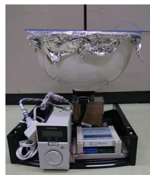
図2：自作スピンのコーター
