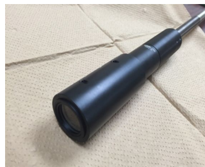
図 1: (左) HYPER-II に設置した遷移プラズマ生成用水冷チャンバー。(右) 真空導入型可動式 LIF 受光計。
