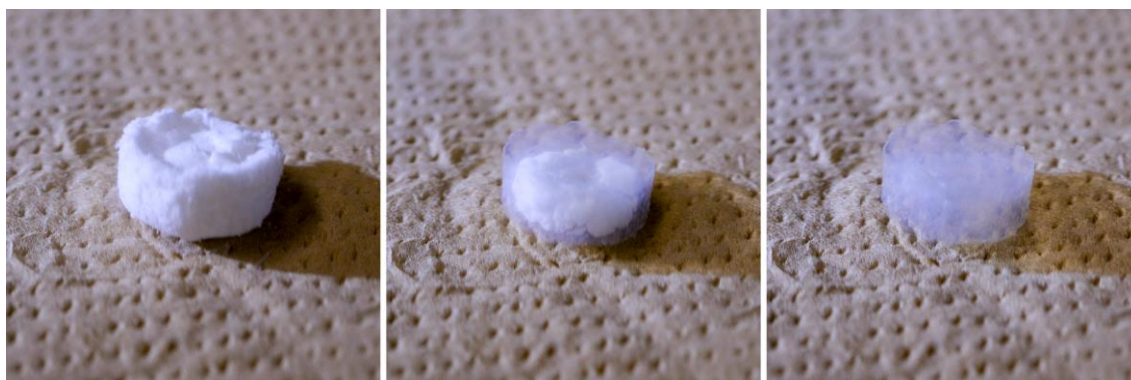
図1 真空凍結乾燥によるクライオゲル作製の様子。昇華が進むにつれ周辺部から半透明になっていく様子がわかる。
