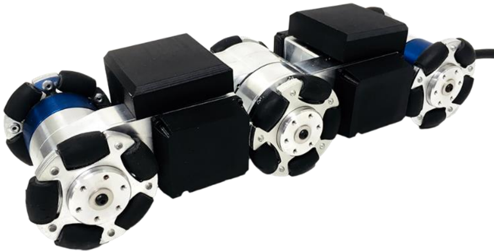
図 7 小型差動弾性アクチュエータ試作 2 号機を用いた配管内移動ロボット
