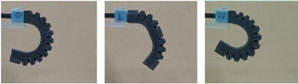
図 4. 異なる設計のソフトアクチュエータの変形
