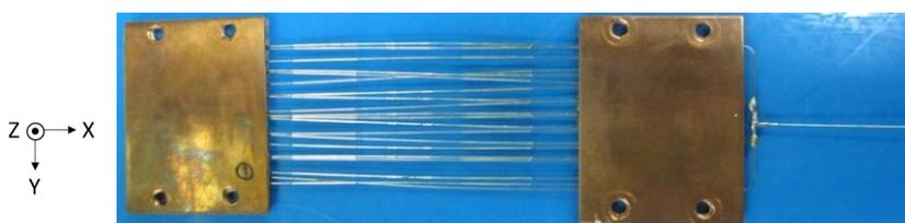
図 6 逆止弁付き極細 OHP 製フレキシブルサーマルストラップ(左は座標系)
