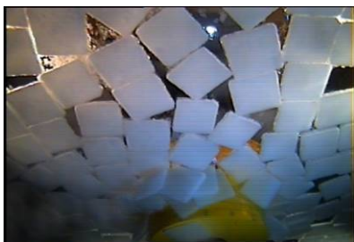
図10 構造物の前下方における氷盤の堆積の様子 (左: 氷海水槽試験、右: fis=fii=0.3)
