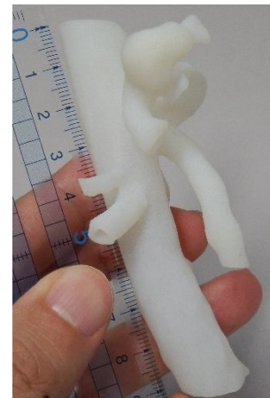
図 1：外注で作成したゴムライクの血管モデル
