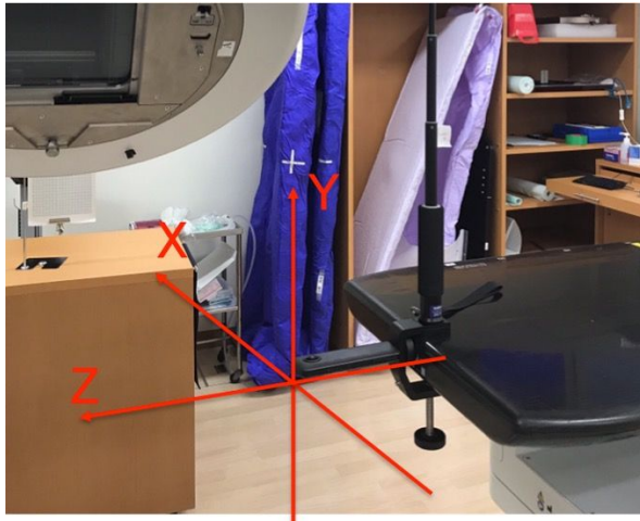
図 2. 全方位カメラのリニアック 寝台への設置
