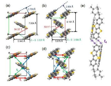
た。その結果を Table 2.4 に示す。Br-BTBT-C<sub>4</sub>には3種類のトランスファー積分が存在している。これはBTBT-C<sub>4</sub>についても同じである。しかし、いずれの値も Br-BTBT-C<sub>4</sub>の方が大きい。これまでに、ヘリングボーン配列の有機半導体において、二面角の角度がより小さい場合、トランスファー積分の値がより大きくなることが報告されており、この計算結果と一致している [4]。トランスファー積分の異方性もBr-BTBT-C<sub>4</sub>のほうが小さく、二次元性が強まっている (83/21  $\pm$  4,50/7  $\pm$  7)。一方で、BTBT-C4 においては、by-layer を形成している二分子間で小さなトランスファー積分が存在している。
