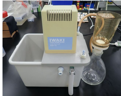
図2.卵殻の半透膜性能を調査するための装置。
