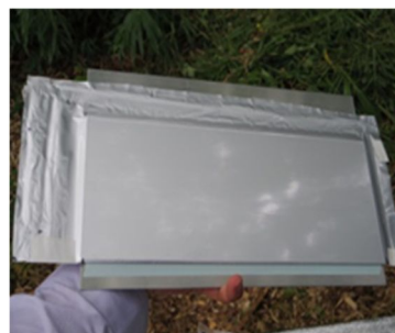
図2. パッキングしてアルミ板に張り付けたフィルム
