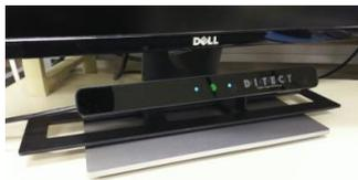
図 3 視線計測装置
