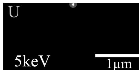
図 3 加速電圧 5 kV におけるモンテカルロ・シミュレーションによるモナザイト中のウラン M 線の発生領域。直径 0.22 ミクロンである。
