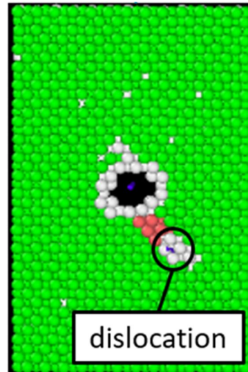
図3 繰り返し負荷下での欠陥生成
