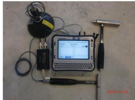
図8 打音検査装置
