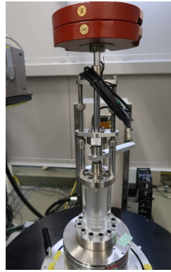
図1 X線CTスキャン用の圧縮試験機
