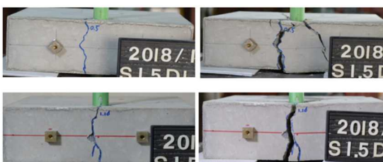
破砕剤によるひび割れ 加力終了後 図12 引抜き実験試験体
