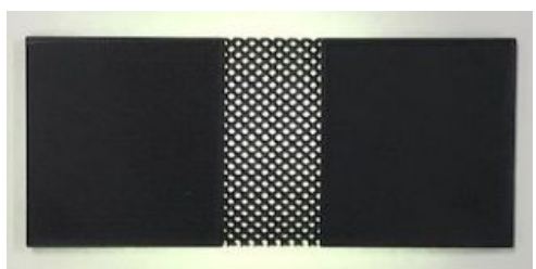
図 4-1 折り畳み可能な CFRP 平板
