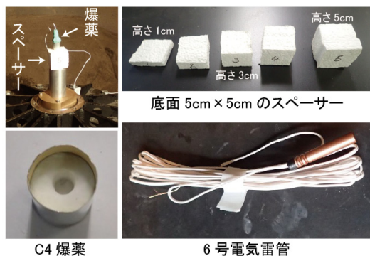
図 5 爆発作用を利用した載荷試験の準備 状況
