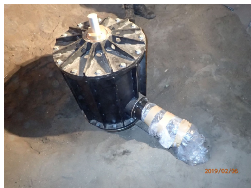
図 4 爆発実験棟内の高速載荷試験装置
