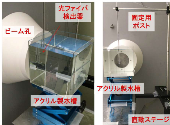
図 4 構築したの液体減速材型中性子スペクトロメータ外観写真
