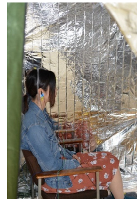
図2:生理計測用移動型自作シールドルーム
