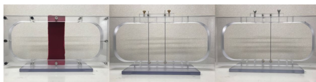
図 6 VHI 実験に使用した資料 (左:ベルベット生地 (R), 中:二本鋼線 (V), 右:コントロールとして用いた一本線 (C))
