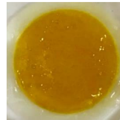
図 2. 基材化したセルロースナノファイバー(乾燥前)
