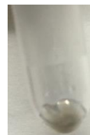
図 4. 白金ナノ粒子を担持したセルロースナノファイバー
