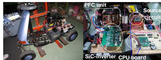
図10 SiCインバータ駆動の電気自動車 (24Vバッテリー駆動)
