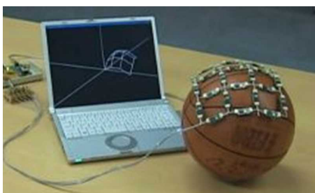
図5 3次元形状計測シートのプロトタイプ。球の表面を覆う柔軟シート(格子状リンク群)が自分自身の形状をリアルタイムで推定し、PCに表示している。
