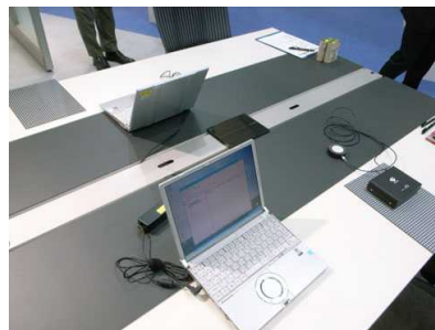
図1 本研究成果の基本原則を応用した実用製品例「LANシート」。アクセスポイントからの電波を通信シートに伝播させる。通信シートに近接したPCのみが通信できる。
