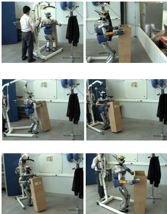
図 7 全身運動による物体搬送計画の実証実験
