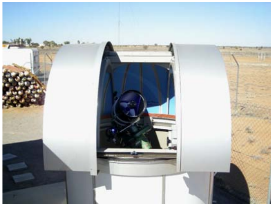
図1. 豪州中央砂漠地帯アリス・スプリングス郊外に設置されたイオ衛星起源プラズマ・ガス遠隔観測装置の全景。2m直径の光学ドームの中に30cm口径反射望遠鏡を前光学系とした高感度分光撮像装置が見えている。光学ドームの傍らに制御棟があり、棟内のコンピュータを介した高速インターネット通信により日本と結ばれている。
