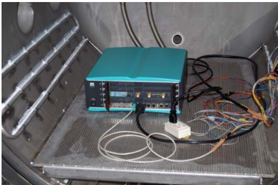
図1：減圧チャンバーにおける動作試験
