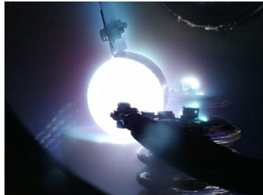
図7 管内壁処理時のプラズマの様子
