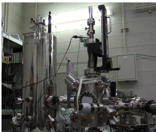
図 2 表面磁気抵抗測定装置の写真。左が試料準備槽で右が磁気抵抗測定槽。
